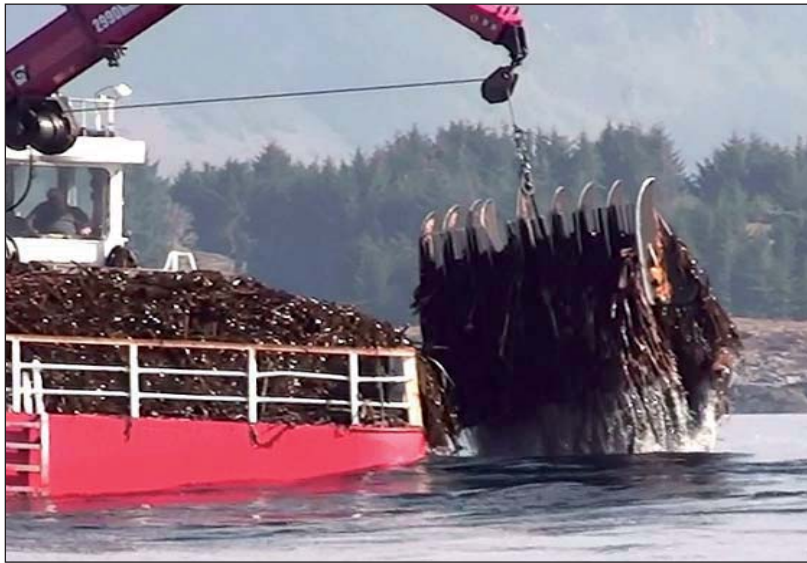
Рис. 10. Норвежская пластинчатая драга для добычи водорослей (Meland, Rebours, 2012) Fig. 10. Norwegian plate dredge for harvesting seaweeds (Meland, Rebours, 2012)
